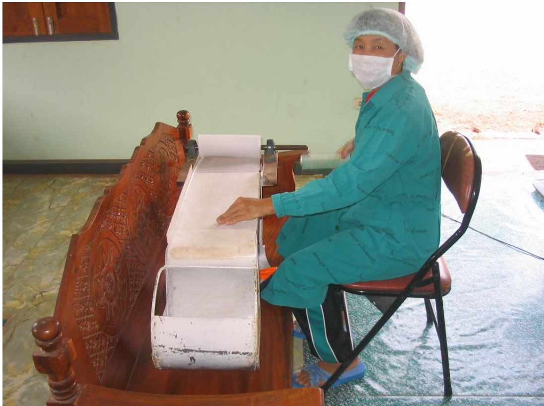
นวัตกรรมเครื่องตัดกอส โรงพยาบาลสร้างคอม ออกแบบโดย นายบุญจันทร์ จิระทาน ตำแหน่ง ลูกมือช่าง
