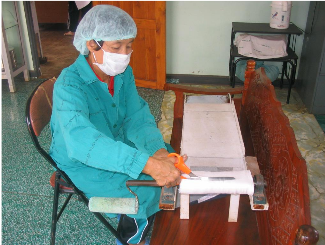
นวัตกรรมเครื่องตัดกอส โรงพยาบาลสร้างคอม ออกแบบโดย นายบุญจันทร์ จิระทาน ตำแหน่ง ลูกมือช่าง
